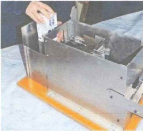
牛乳パックをセットし使用する時、レバーを下げて、セットしたパックを裁断する。(画像の一部を加工しています)
